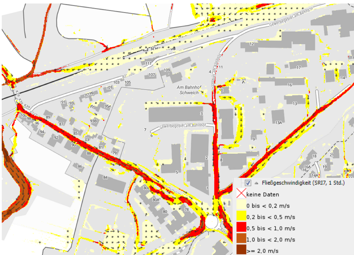
Abbildung 1: Fließgeschwindigkeit und Fließrichtung (Starkregenindex (SRI) 7) (Quelle: Ministerium für Klimaschutz, Umwelt, Energie und Mobilität RLP)
